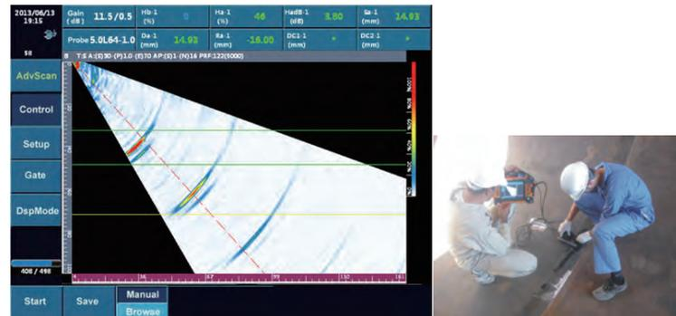
PTS-P05 сканер позволяет проводить контроль сварного соединения одним датчиком на фазированной решетке.
