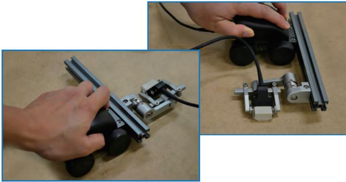
Крепление датчика устанавливается в различных положения для обеспечения необходимого направления сканирования.
