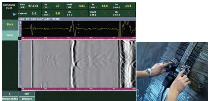
PTS-P05 сканер позволяет проводить контроль одной парой TOFD датчиков.
