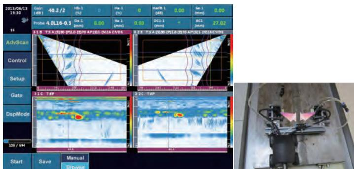
PTS-P05 сканер позволяет проводить контроль с обеих сторон сварного соединения одновременно при помощи двух датчиков на фазированной решетке. Тем самым повышая эффективность и скорость проведения контроля.
