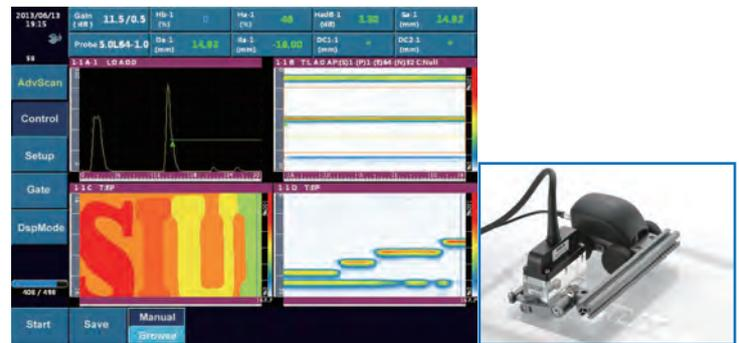
PTS-P05 сканер позволяет проводить контроль с одним большим датчиком на фазированной решетке. Позволяя ускорить процесс контроля.
