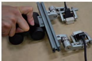
Позволяет проводить контроль одновременно с двух сторон сварного соединения объектов толщиной не более 50 мм.
