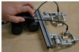
Позволяет проводить контроль объектов толщиной до 50 мм.
